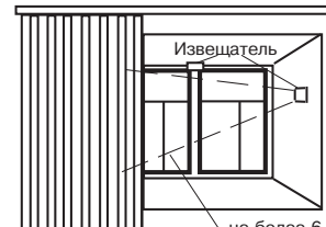
Рисунок 7 – Установка извещателя между стеклом и занавесями (жалюзи) или на раме
